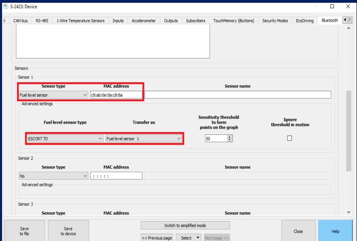
Figure 24 - Setting BLE FLS in the «Sensors» column
